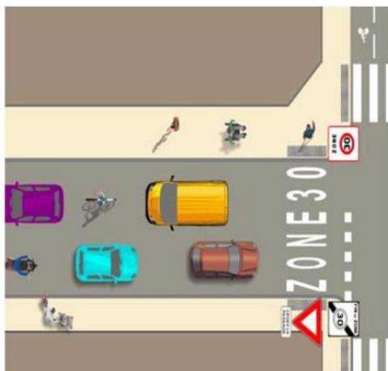
Figure 29 : Principes d'aménagement d'une entrée en zone 30
