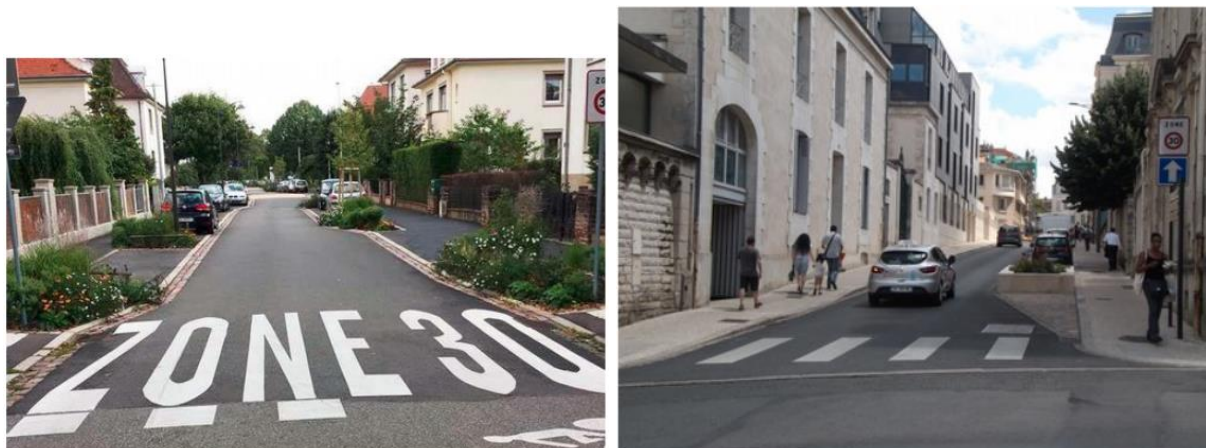
Figure 30 : Exemples d'aménagement d'une entrée en zone 30
